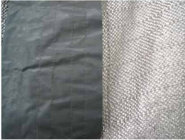
알루미늄증착원단에 일정간격을 두고 직조된 보강경사 및 보강위사와 가두리에 형성된 면당 4회의 재봉선 사진
